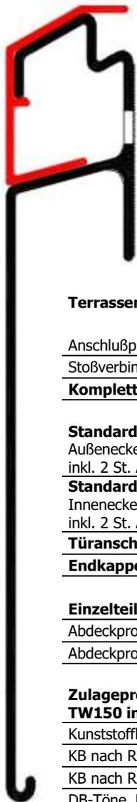
Das COMETEC-Terrassenwandanschlußprofil TW150-S ist die Kombination von TW150 und Abdeckprofil TW für eine vollständig verdeckte Befestigung.
