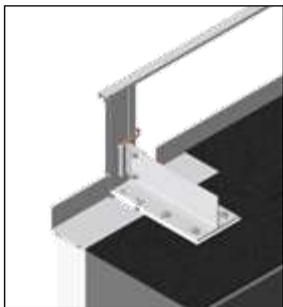
Nach Fertigmontage der Unterkonstruktion, mit Anschluß der Dampfsperre, werden (Gefälle-) Dämmung und Abdichtung verlegt.
