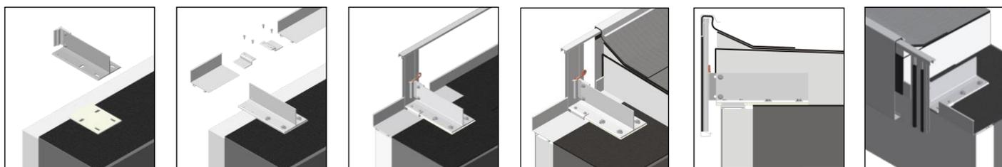
Die Dachrandkonsole wird mit untergelegter Thermostopp-Platte mit 4 zugelassenen Befestigern über den Fassaden-Neuaufbau auskragend montiert.
