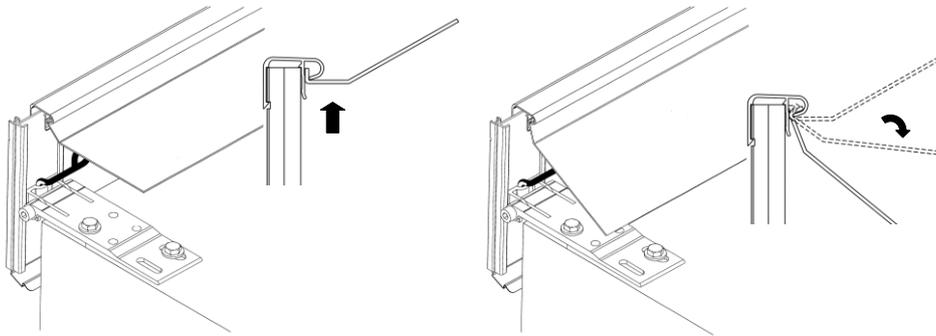
Die Auflageprofile werden von unten in die auf der abgerundeten Innenseite des Trägerprofils dafür vorgesehene Öffnung eingesteckt und anschließend in einer Drehbewegung zur Dachfläche abgesenkt.
