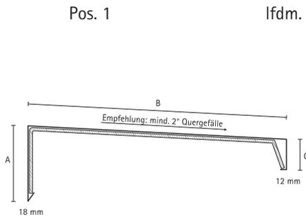
Pos. 1 lfdm. COMETEC-Mauerabdeckprofil
