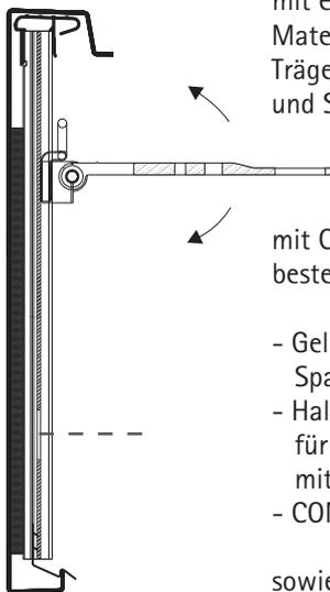
mit COMETEC-Gelenksystemhalter (zum Höhen-/ Neigungs- und Seitenausgleich)
