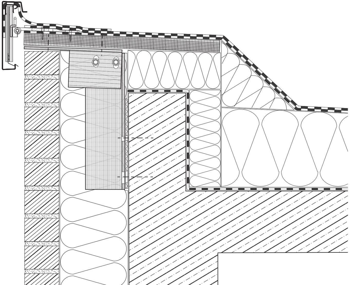
Detail: Flachdachabschluß für Polymerbitumen-Schweißbahn
