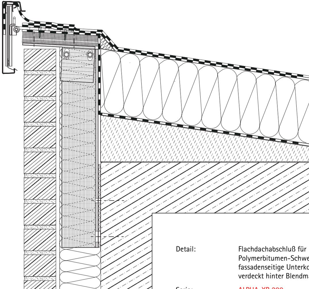
Detail: Flachdachabschluß für Polymerbitumen-Schweißbahn
