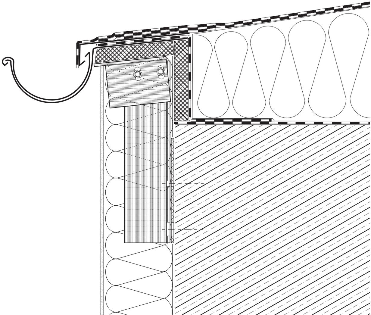
Detail: Flachdachabschluß mit Dachrinne (für Polymerbitumen-Schweißbahn)
