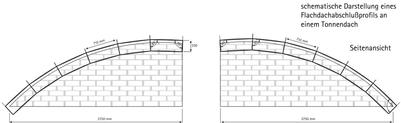
Durch werkseitigen Schrägschnitt der einzelnen Profilstücke, lässt sich auch bei bogenförmigen Baukörpern (z.B. Tonnen- oder Hängedächern) ein sicherer Flachdachabschluß mit ALPHA-X herstellen.
