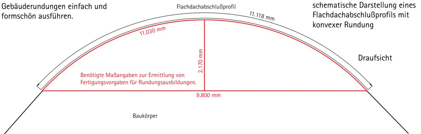
Durch werkseitige Einschnitte der Rückseite von Abschluß- und Trägerprofilen, lässt sich auch bei konvex oder konkav gerundeten Baukörpern ein sicherer Flachdachabschluß mit ALPHA-X herstellen. Die Profile passen sich bei der Montage den Rundungen des Baukörpers an, wobei die vordere Ansichtsfläche als ganze Profillänge durchgehend erhalten bleibt und sich somit eine optisch perfekte Rundung ergibt.
