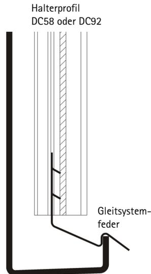
Wichtig: Die Halter DC sind so konstruiert, daß sich die Gleitsystemfedern nach dem Einrasten des Abschlußprofils entspannen. Dadurch wird erreicht, daß die Dachdichtungsbahnen im Profilkopf keinem Druck ausgesetzt sind, der ihre Funktion beeinträchtigt.
