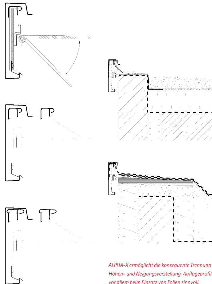
*ALPHA-X ermöglicht die konsequente Trennung von Höhen- und Neigungsverstellung. Auflageprofile sind vor allem beim Einsatz von Folien sinnvoll.*
