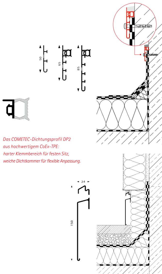
*Das COMETEC-Dichtungsprofil DP2 aus hochwertigem CoEx-TPE: harter Klemmbereich für festen Sitz, weiche Dichtkammer für flexible Anpassung.*
