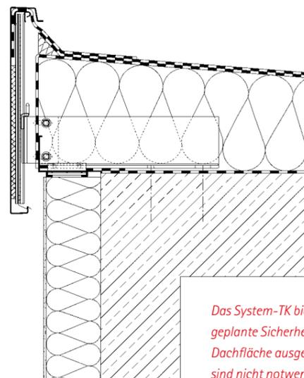
*Das System-TK bietet höchste Variabilität und schafft geplante Sicherheit. Sämtliche Arbeiten können von der Dachfläche ausgeführt werden. Zusätzliche Aufbauten sind nicht notwendig.*
