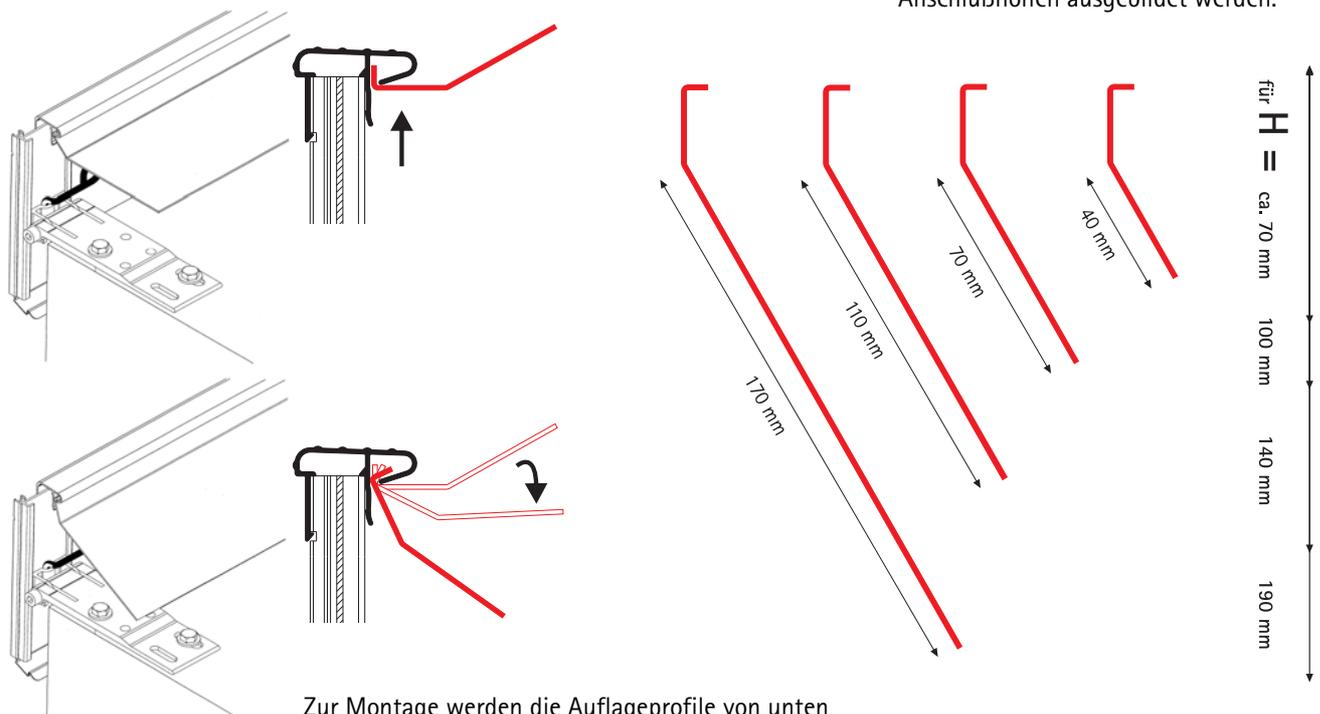
Zur Montage werden die Auflageprofile von unten in die auf der abgerundeten Innenseite des Trägerprofils dafür vorgesehene Öffnung eingesteckt und anschließend in einer Drehbewegung zur Dachfläche abgesenkt.
