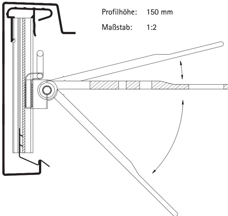
**Gekantete Flachdachabschlußprofile für Folien (hochpolymere Dachdichtungsbahnen)**
